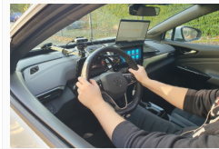
Das SmartCar des PLRI ist mit integrierten Sensoren für EKG, Herz- und Atemfrequenz ausgestattet, die passiv und kontinuierlich die Gesundheit während der Fahrt überwachen. Bildnachweis: PLRI/TU Braunschweig
