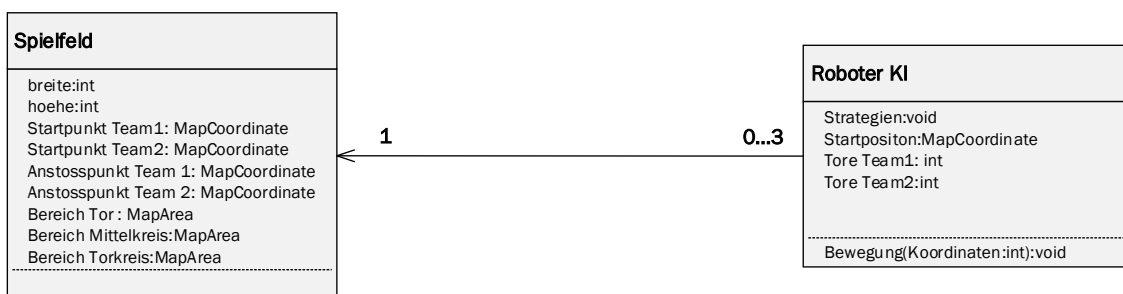
Abbildung 3.1: Klassendiagramm: Dauerhaft zu speichernde Daten
